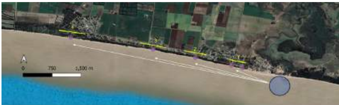
Figura 4-55. Referencias de la zona de préstamo (i.e. círculo azul) y recepción (segmentos amarillos) de la arena en el esquema de refulado propuesto. Los puntos violetas indican los principales accesos a la playa.
